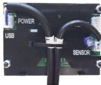
Рисунок 4 - Фиксация проводов на плате контроллера
