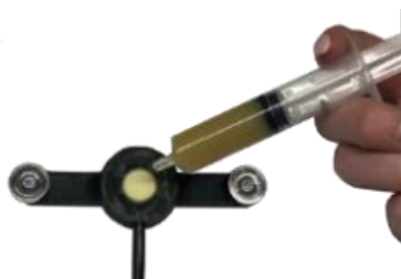
Рисунок 6 - Нанесение смазочной пасты на сенсор
