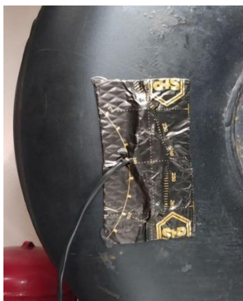
Рисунок 15 - Сенсор, покрытый виброизолятом
